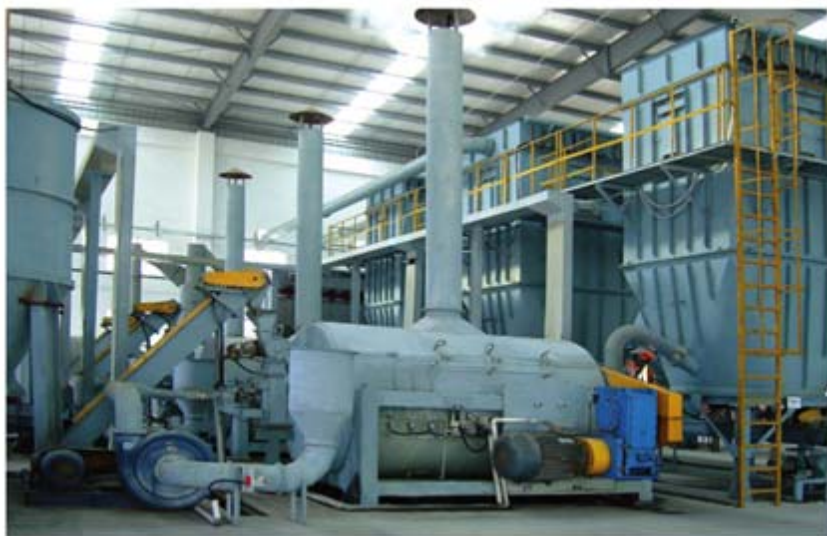
全自动密闭铅粉生产线（张家港金帆电源）
